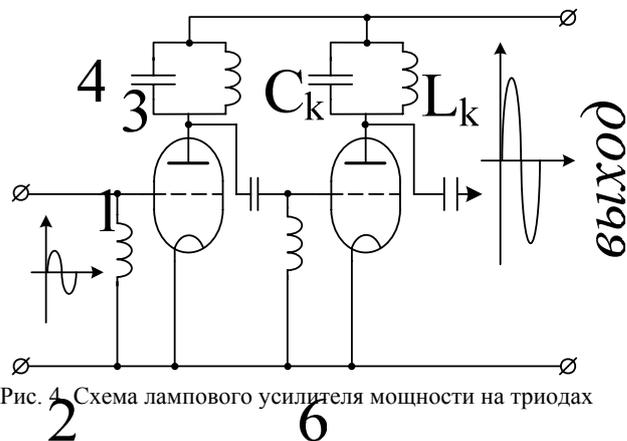
Рис. 4. Схема лампового усилителя мощности на триодах
